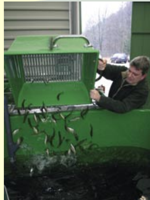
Het sorteerapparaat heeft in de bodem spijlen met een bepaalde tussenafstand, waar de kleine zalmpjes doorheen vallen. De grotere zalmpjes worden vervolgens in een andere bak overgezet.
